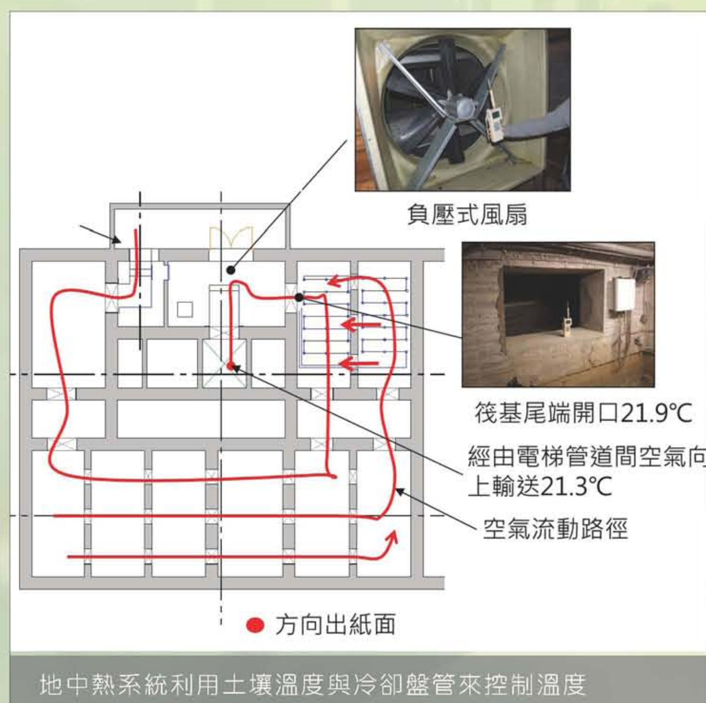
地中熱系統利用土壤溫度與冷卻盤管來控制溫度
