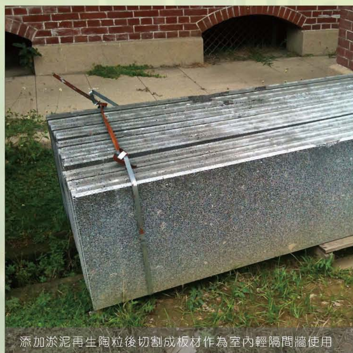
添加淤泥再生陶粒後切割成板材作為室內輕隔間牆使用
